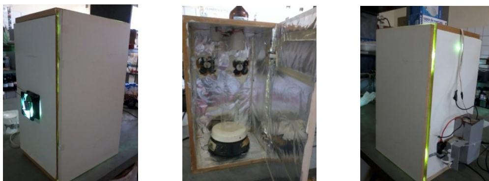
Figura 10. Câmara de fotoreação equipada com uma lâmpada de vapor de mercúrio 125 Watts, um agitador magnético e três culers para resfriamento.
